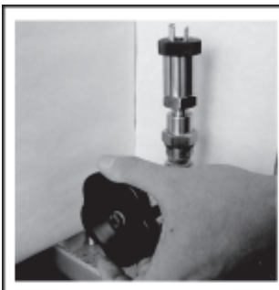
3. 锁入后将压力阀打开 使内部压力达到平衡
